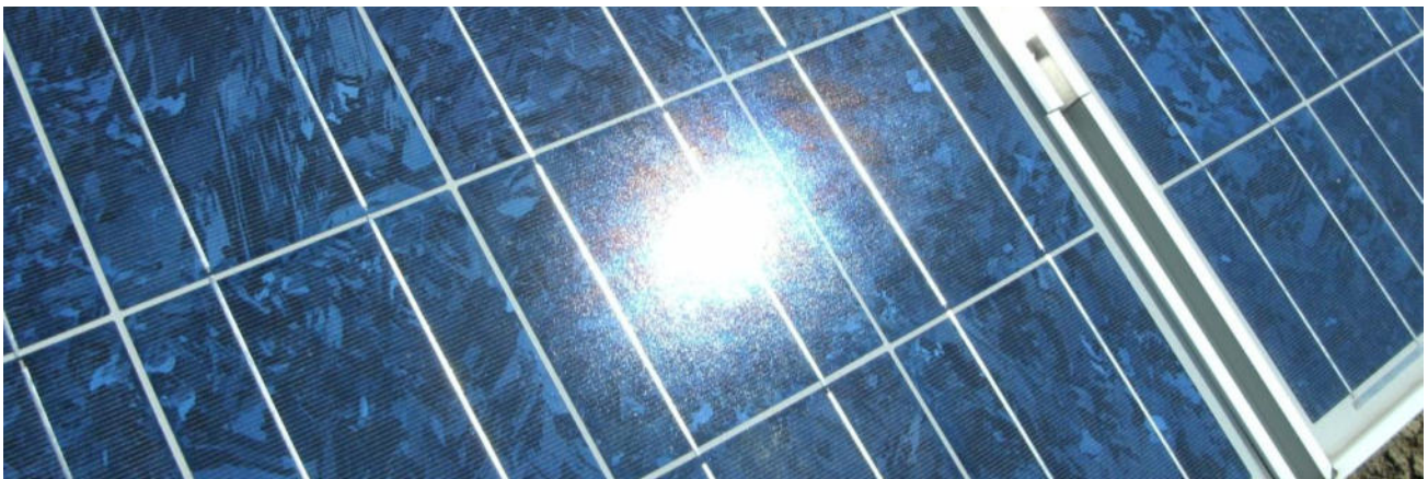
Bild 3.2.2: Diffuse Reflexion von direktem Sonnenlicht (Einstrahlung ca. 980 W/m 2 ) auf einem PV-Modul (Quelle: SolPEG)
