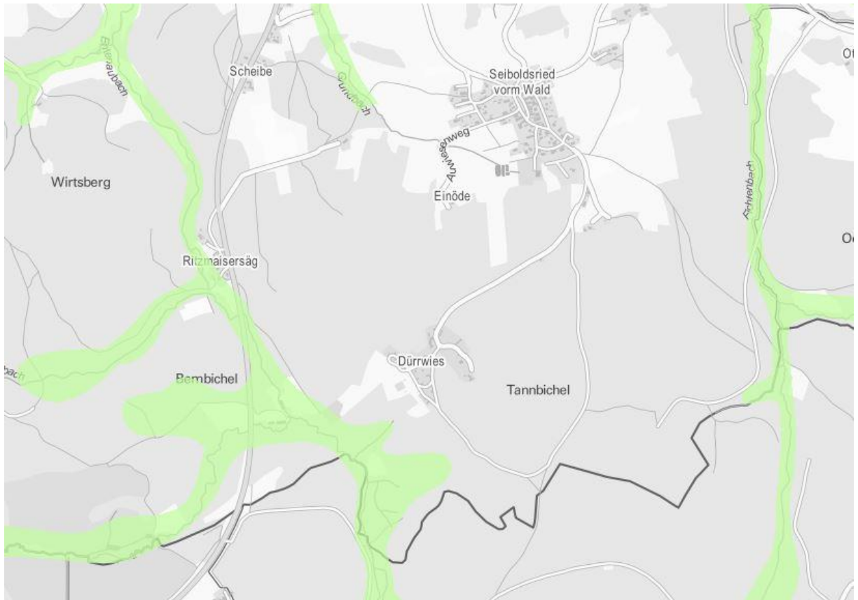
Abbildung 5: Wassersensible Bereiche (Quelle: Bayerisches Landesamt für Umwelt 2016)
